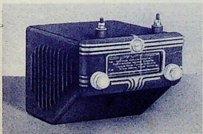
Bild 4. Ansicht des Magnophon-Autosuperhets
